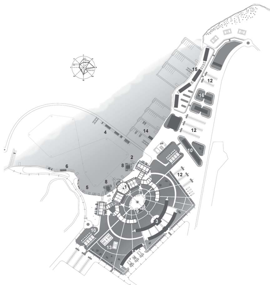
Рис. 7. Генплан комплекса яхт-клуба и мотеля 1 — здание яхт-клуба 2 — поворотные трибуны; 3 — здание мотеля; 4 — стоянка швертботов; 5 — стоянка катамаранов; 6 — стоянка сёрфов; 7 — плац-парад; 8 — площадки спуска-подъёма яхт; 9 — трибуны плац-парада; 10 — эллинг; 11 — АЗС при мотеле; 12 — паркинг легковых автомобилей; 13 — спортплощадка; 14 — пирсы для сдачи в аренду яхт-мест; 15 — эллинги для сдачи в аренду; 16 — гостевое общественно-административное здание;
